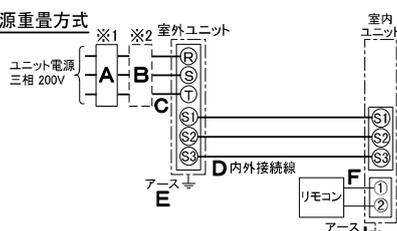
※室内の渡り配線の総延長が80m以上となる場合は、電源重畳方式での配線はできません。必ず(2)内外別受電方式あるいは(3)室外ユニットより室内ユニットに電源を供給する方式にしてください。
