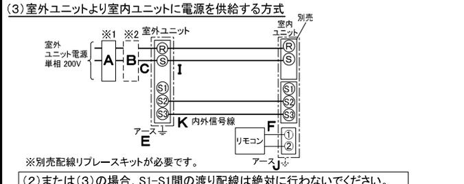
※1. 電源には必ず漏電遮断器を取付けてください。漏電遮断器は、インバーター回路用遮断器(三菱電機製NV-Cシリーズまたは、その同等品)を選定してください。
