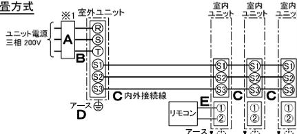
※室内外の渡り配線の総延長が80m以上となる場合は、電源重畳方式での配線はできません。必ず(2)内外別受電方式あるいは(3)室外ユニットより室内ユニットに電源を供給する方式にしてください。
