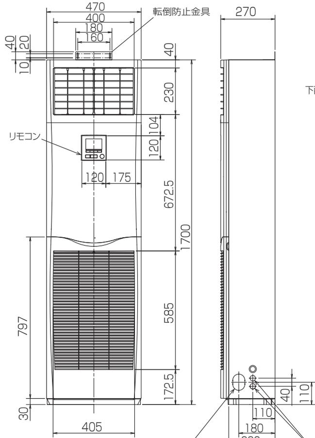
冷媒・ドレン配管用ノックアウト穴
