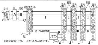
図は同時フォータイプの場合です。 ツインタイプは室内ユニットが2台、トリプルタイプは 室内ユニットが3台となります。
