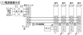
※室内外の渡り配線の総延長が80m以上となる場合は、電源重畳方式での配線はできません。必ず(2)内外別受電方式あるいは(3)室外ユニットより室内ユニットに電源を供給する方式にしてください。
