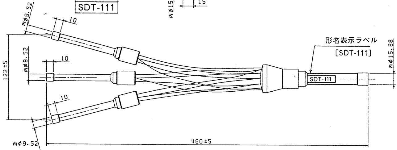
注1) 室内ユニットが35~80形、室外ユニットが200形の場合には、付属のジョイント⑩は必要ありません。その他の場合には配管サイズを確認し、ジョイント⑩を<表1>により特定して冷媒配管を接続してください。
