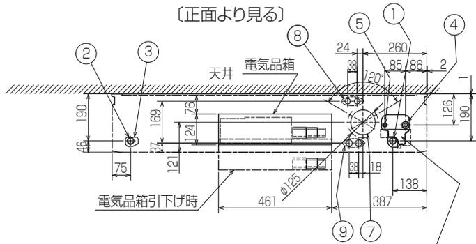
後配管の際、後配管穴が<sup>°</sup>-は斜線部を切り離し必ず元の位置へ取付けて下さい。(埃の進入により、熱交換器が目詰まりするおそれがあります)
