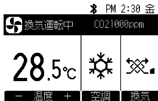
メイン画面(空調換気)
