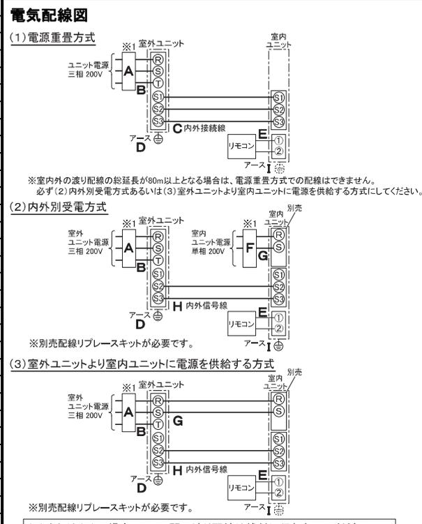
※1. 電源には必ず漏電遮断器を取付けてください。
