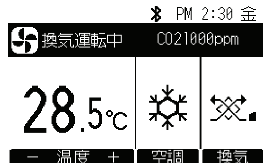
メイン画面(空調換気)
