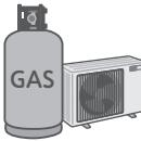
指定冷媒以外は使用(冷媒補充・入替え)しない
