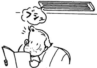
■エアコン内部の冷媒の流れが切替わるときの音です。
