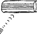
エアコンの内部が湿っているとカビが成長しやすくなります。冷房や除湿でエアコンの内部が湿った後に内部乾燥運転をすることで、エアコン内部でのカビの成長を抑制します。
