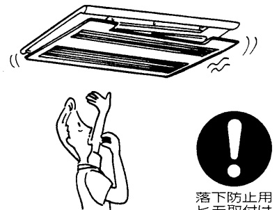
落下防止用ヒモ取付け
