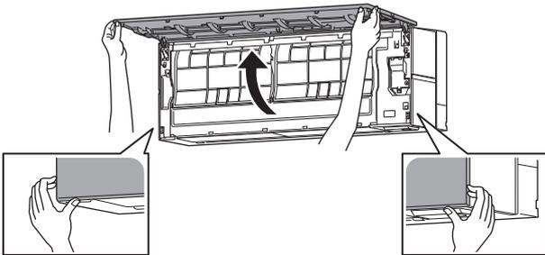
3 前面パネル裏のストッパーを、「カクツ」と手応えがあるまで回転させ、ストッパーの先端を室内機の凹部に入れる。
