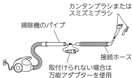
※万能アダプターは、掃除機のパイプ内径29.5~42.5(mm)に対応しています。掃除機の機種によっては、万能アダプターが取付けられない場合があります。
