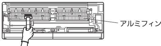
あらかじめ、ダストボックス、抗菌・撥油フッ素フィルター、帯電マイクロフィルター、アレル除菌脱臭空清フィルター [別売] は取外しておく。
