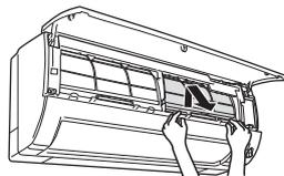
③防カビエアフィルター(裏面)の取付部から両端の爪部に指を掛け、外側に広げながら帯電マイクロフィルターを取外します。
