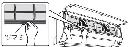
**3** 取外した防カビエアフィルターのほこりを掃除機で吸い取るか、水洗いをして、風通しのよい日陰でよく乾かしてください。
