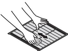
※スポンジなどで矢印方向にかたく拭き取ってください。フィルターを押さえつけて、変形させないでください。
