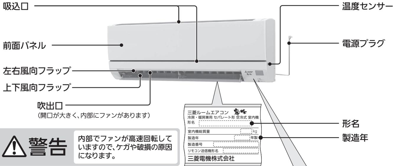
**警告** 内部でファンが高速回転していますので、ケガや破損の原因になります。
