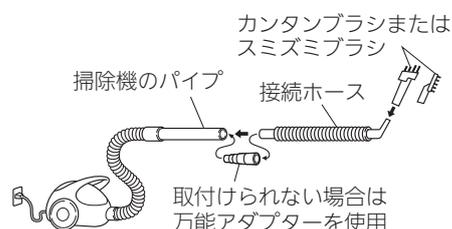
※万能アダプターは、掃除機のパイプ内径29.5~42.5(mm)に対応しています。掃除機の機種によっては、万能アダプターが取付けられない場合があります。
