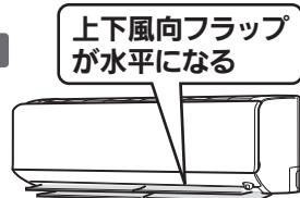
運転を止めたのに止まらない。クリーンランプ“★”が点灯して上下風向フラップが水平に開く。
