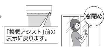
※「換気アシスト」中にリモコンを操作すると、「換気アシスト」は取り消され、リモコンの設定内容で運転します。
