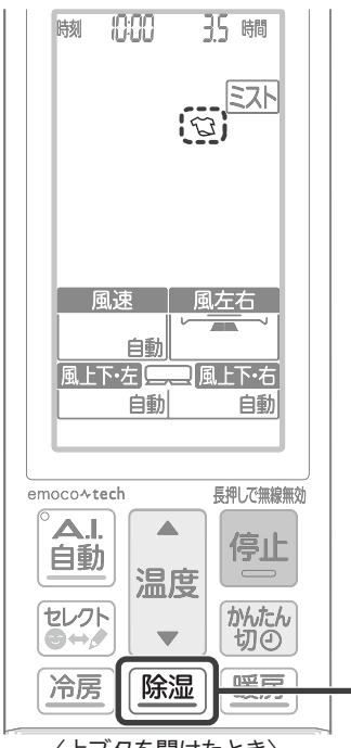
洗濯物の乾燥に適した運転を約3時間30分間行い、自動で運転を停止します。
