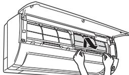
③清潔Vフィルターを少したわませながら、プラチナアレル除菌空清フィルター両端の爪部の引っ掛かりを外します。
