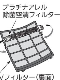
②清潔Vフィルターの爪部を室内機に確実にはめ、取り付ける。
