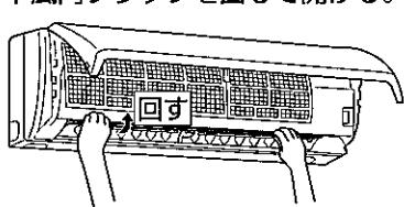
②上下風向フラップの両端を持ち、上下風向フラップを回して開ける。
