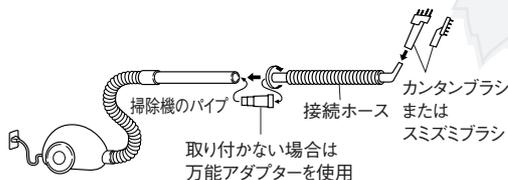
専用以外のものを使用すると金属部(熱交換器)などの破損の原因となりますので、専用ブラシを使うことをおすすめします。詳細は専用おそうじカンタンセットの取扱説明書をごらんください。
