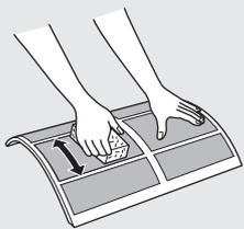
※矢印方向にかたくスポンジ等で拭き取ってください。フィルターを押さえつけて、変形させないでください。
