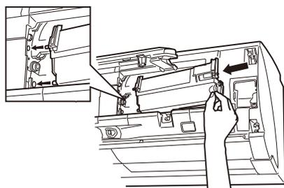
エアフィルターの上からダストボックスの突起部(2か所)を本体の穴に横から差し込む
