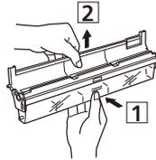
2 ダストボックスのカバーを矢印の方向に回転させる
