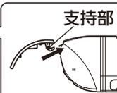
丸洗いパネルを両手で持ち、矢印の方向から支持部が“カチッ”と音がするまで溝に差し込みます。
