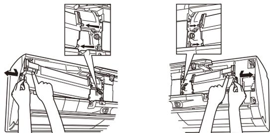
ダストボックス側面の取っ手を持って、白いストッパーを押さえながら、手前に約4cm引き出し、矢印の方向に引き抜くように取り出す
