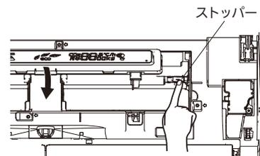
ダストボックスを“カチッ”と音がするまで押し込み、白いストッパーで固定されていることを確認し、表示部を押し下げる
