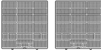
①両手で丸洗いパネルの左右下側を同時に引き、“カクッ”と止まる位置まで持ち上げる。
