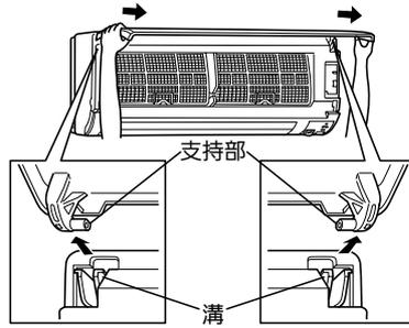
丸洗いパネルは無理に引抜いたり、落下させないでください。丸洗いパネル破損の原因になります。
