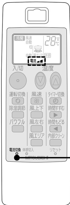
運転中に **電流切換** を先の細いもので押す
