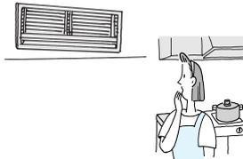
■換気扇やガスコンロを使用する部屋では、冷房負荷が大きくなり、冷えが悪い場合があります。
