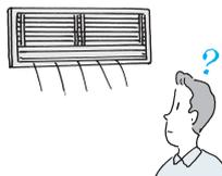
■暖房運転時の吹出し空気温度が低いとき、または霜取運転中は自動的に水平吹出しになります。
