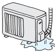
■冷房時に、冷えた配管や配管接続部に水滴がつき、滴下するためです。
