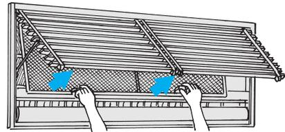
3 取外したカテキンエアフィルターのホコリを掃除機で吸取るか、水洗いをしたあと、日陰でよく乾かす。
