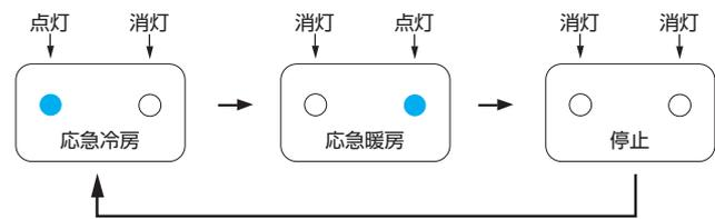
停止するときは応急運転スイッチを押して「停止」にする。
