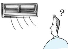
■部屋の空気中の水分が、エアコンから吹出した冷たい風で急速に冷やされ霧状になるためです。
