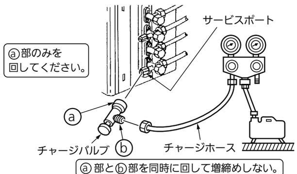
**チャージバルブをサービスポートに取付ける際に締め過ぎるとバルブコア（虫ピン）の変形・緩みによるガス漏れのおそれがあります。**
