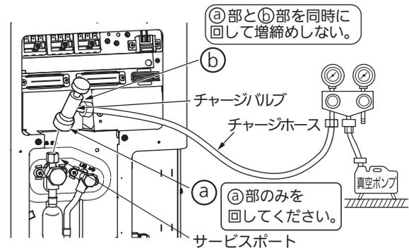
チャージバルブをサービスポートに取付ける際に締め過ぎるとバルブコア（虫ピン）の変形・緩みによるガス漏れのおそれがあります。
