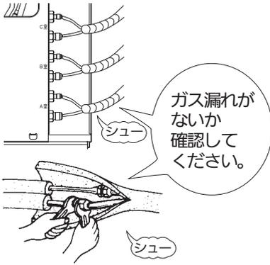
② 内外接続電線の誤配線 / 配管接続の誤配管
