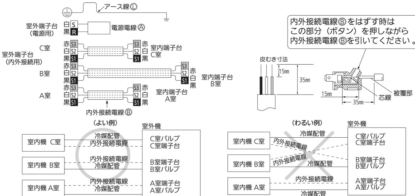
**警告** 端子台へ電線を接続する際には芯線がかくれるまで確実に押し込み各々の線が引っ張って抜けないことを確認してください。挿入が不十分ですと端子台が焼損することがあります。
