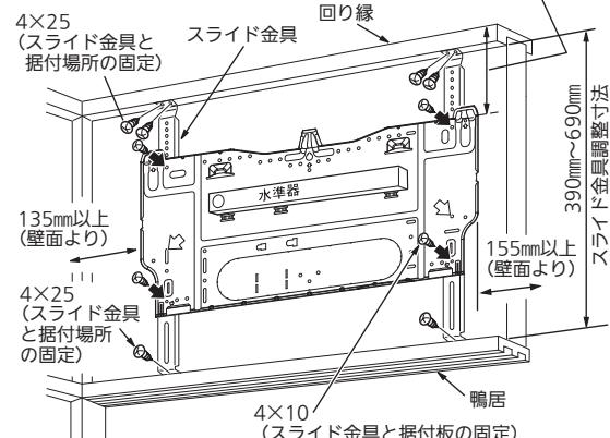
据付板①のノックアウトを使用する場合は、板金端面全周に傷つき防止用のビニールテープ(現地手配)を貼ってください。公団アパート用穴使用時は、アンカーボルトの壁面からの飛び出し代が15mm以下になるようカットしてください。
