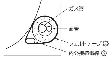
フェルトテープ④は、室内機裏側を通る配管の右端から左端まですべて必ず巻いてください。
