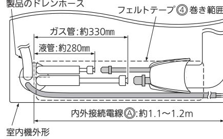
冷媒配管(内外接続配管)⑥の引込み長さの目安として、据付板①に記載の本体配管接続部の略図もご覧ください。買替えなどで冷媒配管(内外接続配管)⑥が届かない場合があります。その場合は「ユニオン付延長継手」(別売部品)をご使用ください。
