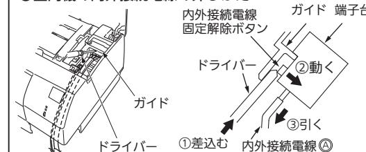
左図のように、端子台手前のガイドにドライバーを差込むことにより、内外接続電線固定解除ボタンが押され、内外接続電線④を引くと外すことができます。
