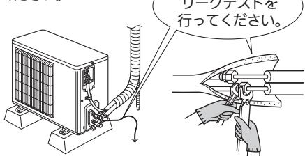
規定トルク外の締付けはフレアからのガス漏れの原因となります。
