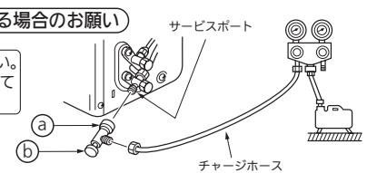
チャージバルブをサービスポートに取付ける際に締め過ぎるとバルブコア(虫ピン)の変形・緩みによるガス漏れのおそれがあります。チャージバルブの軸が変形していたり、パッキンが劣化していると、ガス漏れの原因になります。
