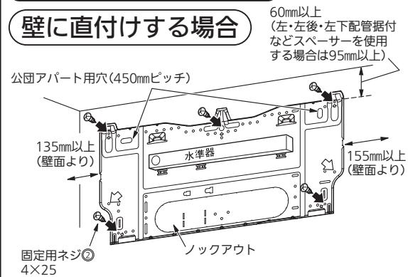
壁内の構造体(間柱など)をさがして強固に取付けてください。
