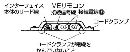
アース線をバンド⑬にて、電源電線に固定する。 MEリモコン接続信号線 MEリモコンの接続信号線をインターフェイス本体へ挿入するときは、必ず接続電線⑧と同じ入り口から挿入し、左図のように接続電線⑧の横を通り、重ねて固定しないでください。
