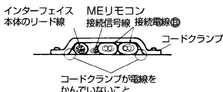
アース線をバンド⑬にて、電源電線に固定する。
