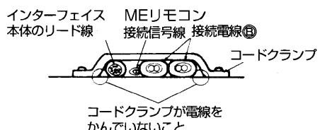
アース線をバンド⑨にて、電源電線に固定する。 MEリモコン接続信号線
