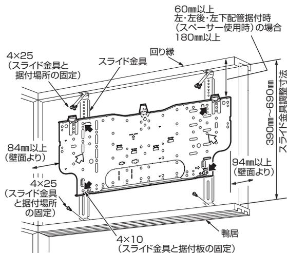
据付板①の微振動を防ぐため、**位置の穴は必ず固定してください。**
