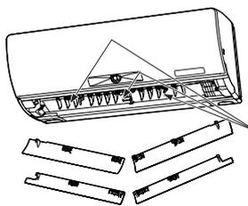
安心ストッパーが正しく差込まれていないと、全てのランプとデジタル表示の「Fl」が同時に点滅して、エアコンが運転できなくなります。
