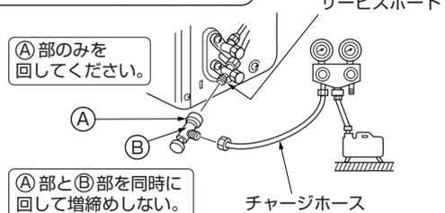
チャージバルブをサービスポートに取付ける際に締め過ぎるとバルブコア(虫ピン)の変形・緩みによるガス漏れのおそれがあります。
