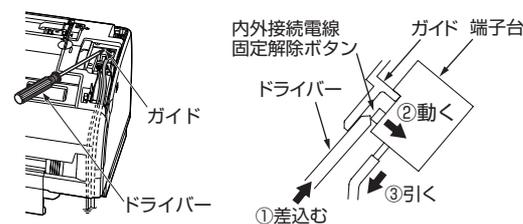
左図のように、端子台手前のガイドにドライバーを差込むことにより、内外接続電線固定解除ボタンが押され、内外接続電線⑤を引くと外すことができます。
