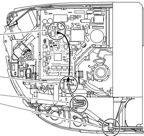
⚠ 警告 接続ケーブルは所定の位置に確実に固定してください。正しく固定されないと、感電・火災・故障の原因となります。
