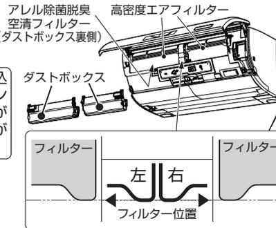
ダストボックスを引き出し、高密度エアフィルターが図のようにセットされているかチェックしてください。
