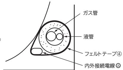
フェルトテープ④は、室内ユニット裏側を通る配管の右端から左端まですべて必ず巻いてください。
