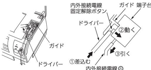
左図のように、端子台手前のガイドにドライバーを差込むことにより、内外接続電線固定解除ボタンが押され、内外接続電線◎を引くと外すことができます。
