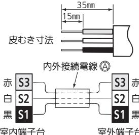
電線固定具の左側のツメを引っ掛けて内外接続電線④を必ず固定してください。
