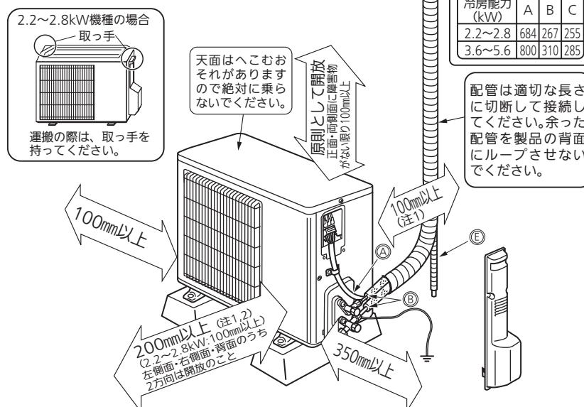
※上記の印寸法は、エアコンの性能を保証するために必要な空間です。後のサービス、補修なども考慮してできるだけ周囲の空間が大きくなる場所に据付けてください。
