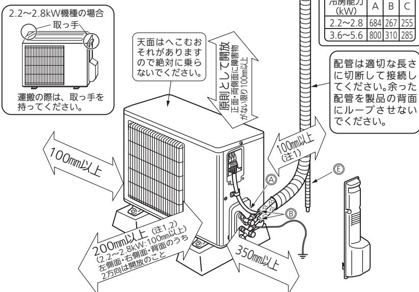
※上記の印寸法は、エアコンの性能を保証するために必要な空間です。後々のサービス、補修なども考慮してできるだけ周囲の空間が大きくとれる場所に据付けてください。
