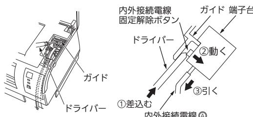
左図のように、端子台手前のガイドにドライバーを差込むことにより、内外接続電線固定解除ボタンが押され、内外接続電線⑥を引くと外すことができます。
