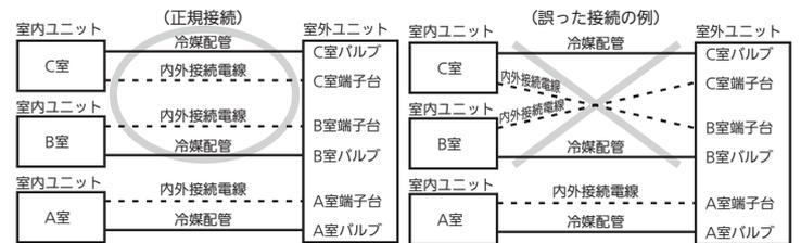
冷媒配管および内外接続電線は、各室内ユニットに対応する室外ユニット側のバルブおよび端子台に確実に接続してください。冷媒配管と内外接続電線の部屋室名を合わせないで運転した場合、室内ユニットからの水漏れや圧縮機の故障の原因になります。
