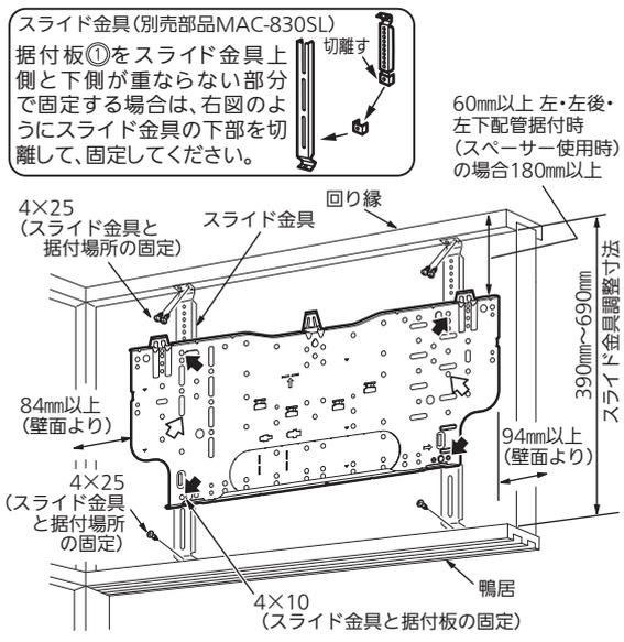
据付板①の微振動を防ぐため、**位置の穴は必ず固定してください。**
