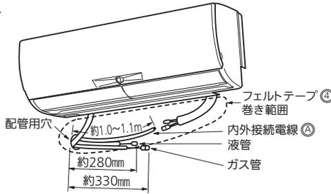
冷媒配管(延長配管)⑧の引込み長さの目安として、据付板①に記載の本体配管接続部の略図もご覧ください。買替えなどで冷媒配管(延長配管)⑧が届かない場合があります。その場合は「ユニオン付延長継手」(別売部品)をご使用ください。
