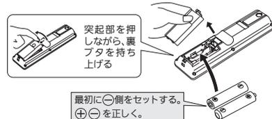
(2) 「リセット」ボタンを押し、裏ボタンを取付けます。「リセット」ボタンを押さないと、正しく動作しないことがあります。
