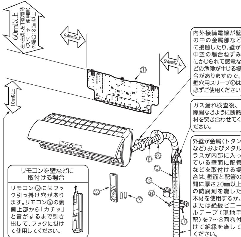
注:カーテンレールなどが壁から70mmを超えて突き出す場合には、吹き出し airflow がショートサイクルを起こす場合がありますので、さらに十分な距離をとってください。
