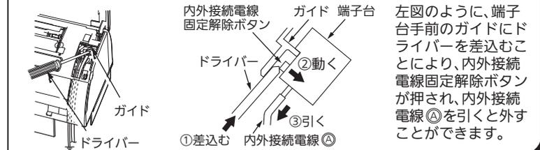
左図のように、端子台手前のガイドにドライバーを差込むことにより、内外接続電線固定解除ボタンが押され、内外接続電線⑨を引くと外すことができます。
