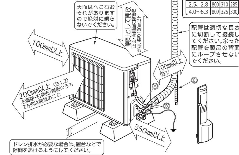
※上記の(⇔)印寸法は、エアコンの性能を保証するために必要な空間です。後々のサービス、補修なども考慮してできるだけ周囲の空間が大きくとれる場所に据付けしてください。
