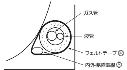
フェルトテープ④は、室内ユニット裏側を通る配管の右端から左端まで全て必ず巻いてください。
