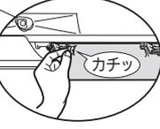
安心ストッパーが正しく差込まれていないと、すべてのランプと体感温度モニターの「F.L」が同時に点滅して、エアコンが運転できなくなります。
