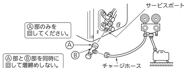
チャージバルブをサービスポートに取付ける際に締め過ぎるとバルブコア(虫ピン)の変形・緩みによるガス漏れのおそれがあります。
