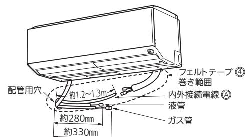
冷媒配管(内外接続配管)<sup>⑥</sup>の引込み長さの目安として、据付板<sup>①</sup>に記載の本体配管接続部の略図もご覧ください。
