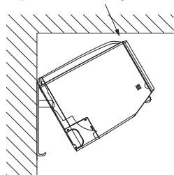
(2)冷媒配管、ドレンホースを接続します。
