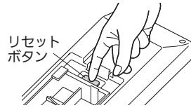
(3)リモコン⑤の「運転切／入」ボタンを押して、室内ユニット本体が「ピッ」と鳴るのを確認してください。もう1回ボタンを押して「切」にしてください。
