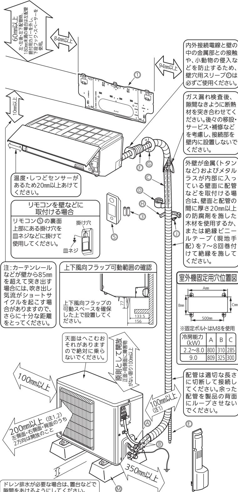
※上記の印寸法は、エアコンの性能を保証するために必要な空間です。後々の移設・サービス・補修なども考慮してできるだけ周囲の空間が大きくなる場所に据付けてください。
