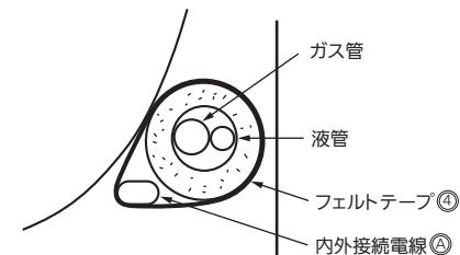
フェルトテープ<sup>④</sup>は、室内機裏側を通る配管の右端から左端まで全て必ず巻いてください。
