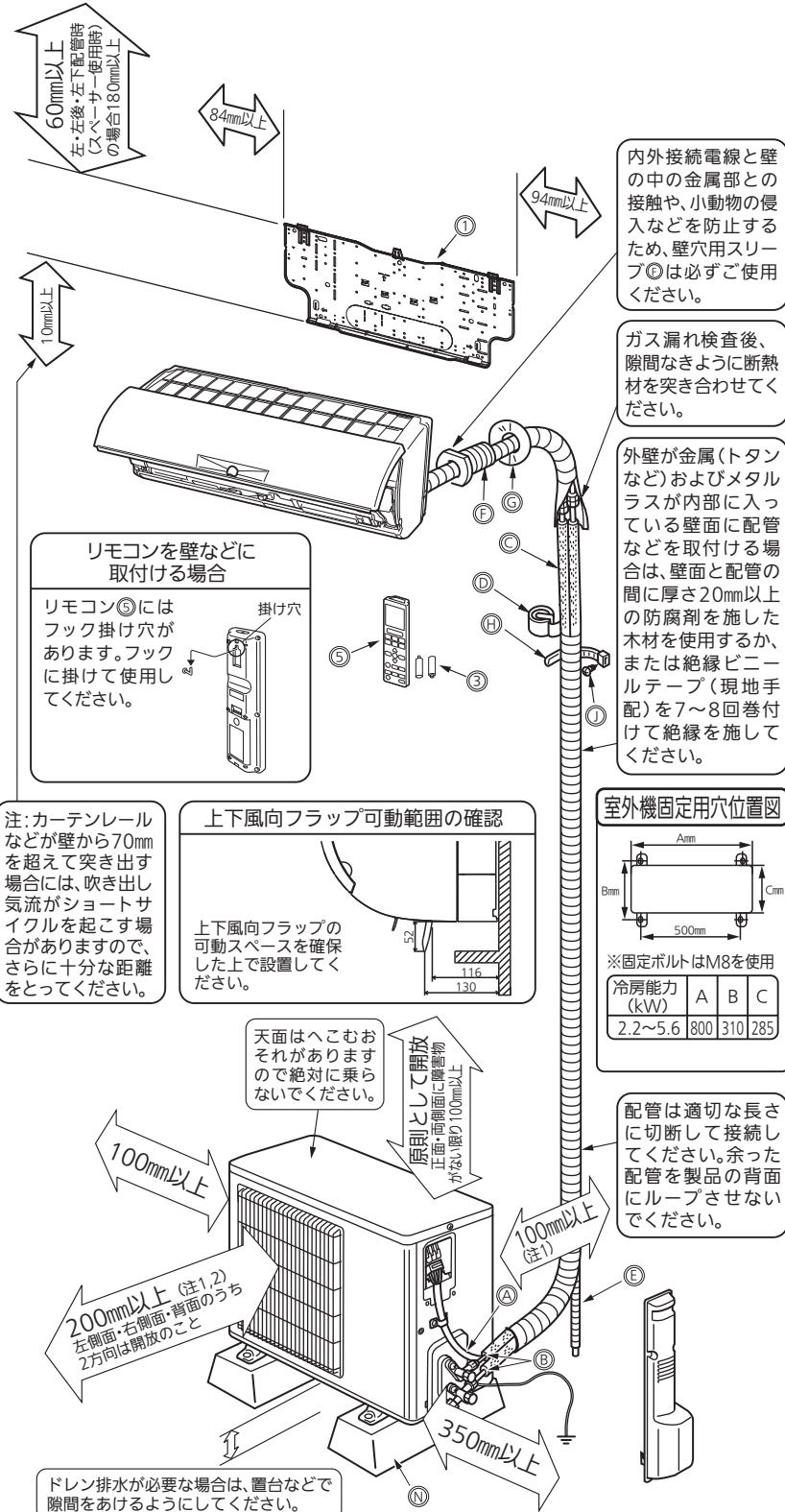
※上記の印寸法は、エアコンの性能を保証するために必要な空間です。後々のサービス、補修なども考慮してできるだけ周囲の空間が大きくとれる場所に据付けしてください。
