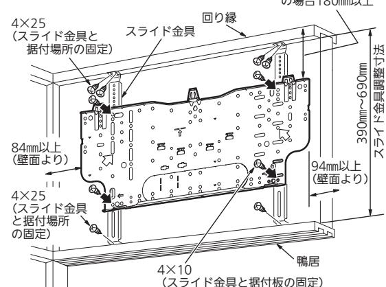
据付板①のノックアウトを使用する場合は、板金端面全周に傷つき防止用のビニールテープ(現地手配)を貼ってください。
