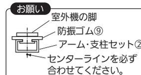
※防振ゴム⑨は、必ずアーム・支柱セット②のアームの溝に対し直角にご使用ください。
