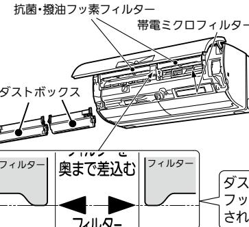
●帯電ミクロフィルター、抗菌・撥油フッ素フィルター、ダストボックスが正しく取付けられていないと、体感温度モニターの「F」が点滅します。
