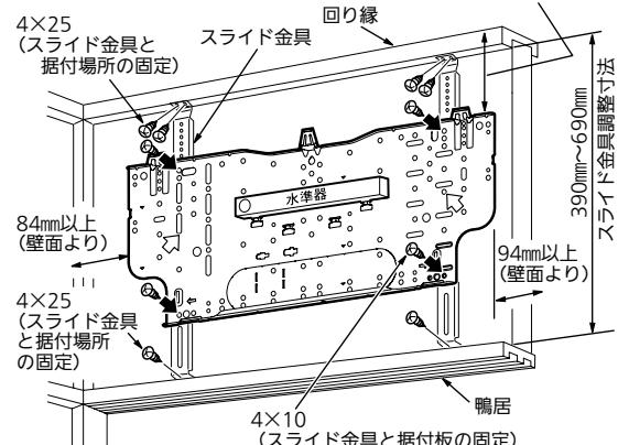
据付板①のノックアウトを使用する場合は、板金端面全周に傷つき防止用のビニールテープ(現地手配)を貼ってください。
