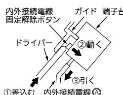
左図のように、端子台手前のガイドにドライバーを差込むことにより、内外接続電線固定解除ボタンが押され、内外接続電線④を引くと外すことができます。
