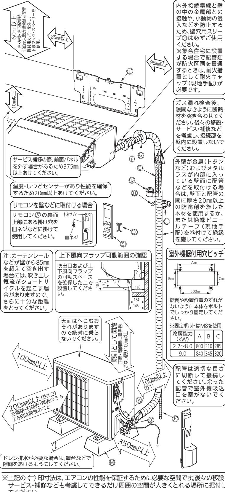
※上記の印寸法は、エアコンの性能を保証するために必要な空間です。後々の移設・サービス・補修なども考慮してできるだけ周囲の空間が大きくなる場所に据付けてください。
