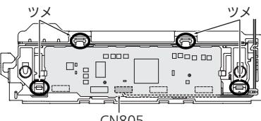
[図3]接続ケーブルの格納
