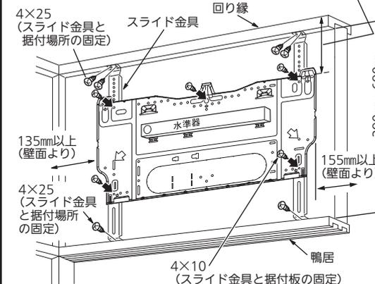
据付板○のノックアウトを使用する場合は、板金端面全周に傷つき防止用のビニールテープ(現地手配)を貼ってください。公団アパート用穴使用時は、アンカーボルトの壁面からの飛び出し代が15mm以下になるようカットしてください。
