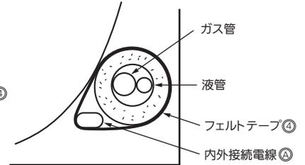
フェルトテープ㉑は、室内機裏側を通る配管の右端から左端まですべて必ず巻いてください。
