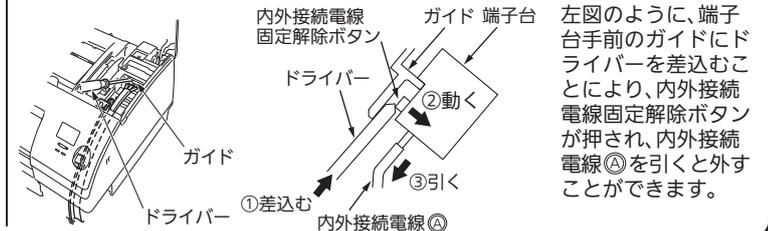
左図のように、端子台手前のガイドにドライバーを差込むことにより、内外接続電線固定解除ボタンが押され、内外接続電線㉓を引くと外すことができます。
