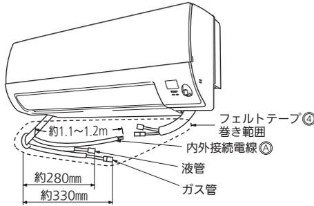
冷媒配管(内外接続配管)㉑の引込み長さの目安として、据付板㉒に記載の本体配管接続部の略図もご覧ください。買替えなどで冷媒配管(内外接続配管)㉑が届かない場合があります。その場合は「ユニオン付延長継手」(別売部品)をご使用ください。
