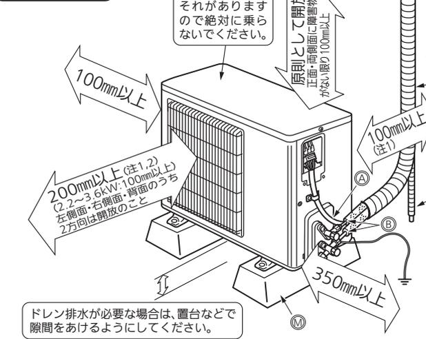
※上記の(⇔)印寸法は、エアコンの性能を保証するために必要な空間です。後々のサービス、補修なども考慮してできるだけ周囲の空間が大きくとれる場所に据付けてください。
