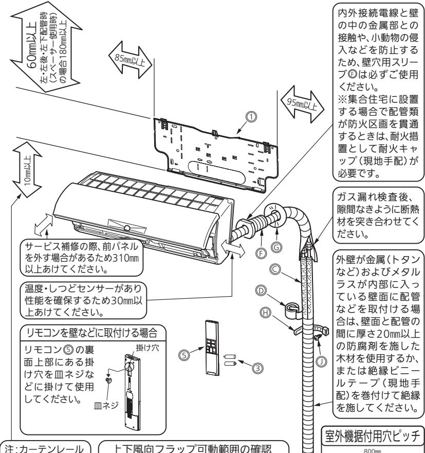
注:カーテンレールなどが壁から70mmを超えて突き出す場合には、吹き出し気流がショートサイクルを起こす場合がありますので、さらに十分な距離をとってください。
