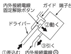
左図のように、端子台手前のガイドにドライバーを差込むことにより、内外接続電線固定解除ボタンが押され、内外接続電線④を引くと外すことができます。
