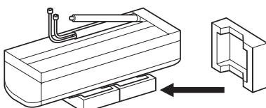
●配管曲げ作業は根元を手で押さえ、室内機内部の配管に力が加わらないようにしてください。
