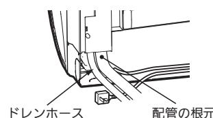
●冷媒配管、ドレンホースをまとめて配管テープ(7)でテーピングします。配管テープ(7)を根元近くからしっかりと巻いてください。
