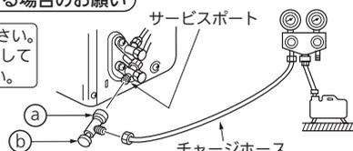
チャージバルブをサービスポートに取付ける際に締め過ぎるとバルブコア(虫ピン)の変形・緩みによるガス漏れのおそれがあります。チャージバルブの軸やパッキンが劣化していると、ガス漏れの原因になります。
