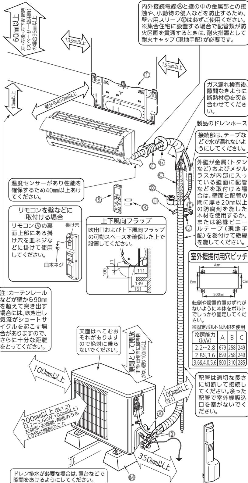
※上記の(⇔)印寸法は、エアコンの性能を保証するために必要な空間です。後々のサービス、補修なども考慮してできるだけ周囲の空間が大きくとれる場所に据付けてください。
