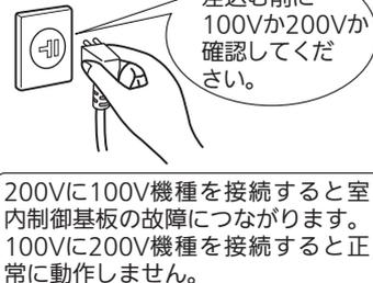
200Vに100V機種を接続すると室内制御基板の故障につながります。100Vに200V機種を接続すると正常に動作しません。
