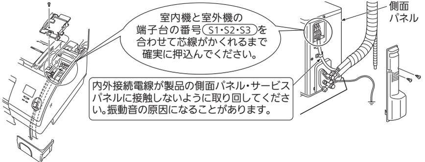
内外接続電線が製品の側面パネル・サービスパネルに接触しないように取り回してください。振動音の原因になることがあります。
