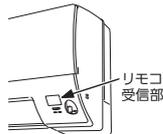
リモコン⑩で操作した場合は、リモコン⑩の指令に従い、試運転、応急運転がともに解除されます。
