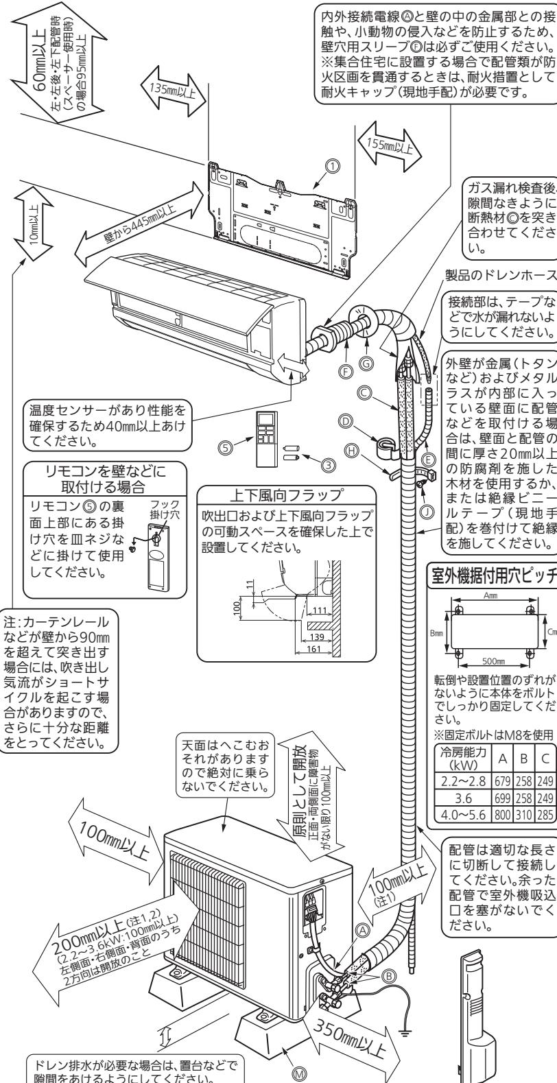
※上記の印寸法は、エアコンの性能を保証するために必要な空間です。後々のサービス、補修なども考慮してできるだけ周囲の空間が大きくなる場所に据付けてください。
