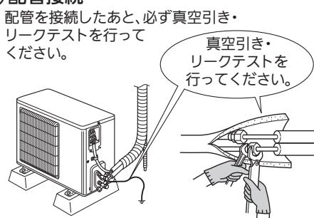
規定トルク外の締付けはフレアからのガス漏れの原因となります。
