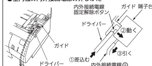
左図のように、端子台手前のガイドにドライバーを差込むことにより、内外接続電線固定解除ボタンが押され、内外接続電線⑧を引くと外すことができます。
