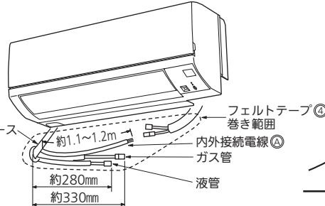
冷媒配管(内外接続配管)⑨の引込み長さの目安として、据付板①に記載の本体配管接続部の略図もご覧ください。
