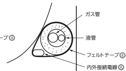
フェルトテープ④は、室内機裏側を通る配管の右端から左端まですべて必ず巻いてください。
