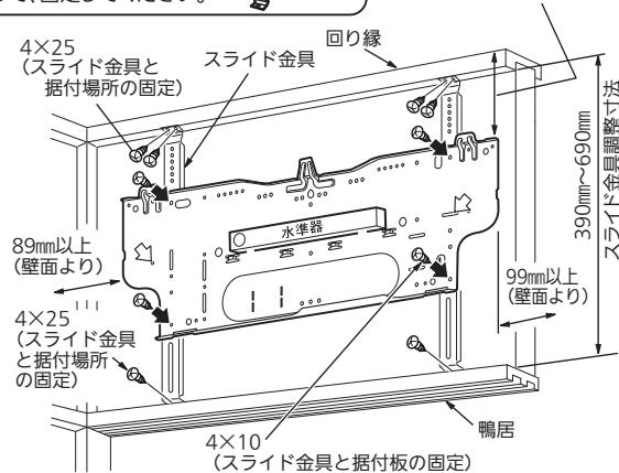
据付板①のノックアウトを使用する場合は、板金端面全周に傷つき防止用のビニールテープ(現地手配)を貼ってください。
