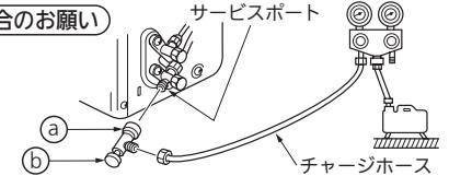
チャージバルブをサービスポートに取付ける際に締め過ぎるとバルブコア(虫ビン)の変形・緩みによるガス漏れのおそれがあります。チャージバルブの軸が変形していたり、パッキンが劣化していると、ガス漏れの原因になります。
