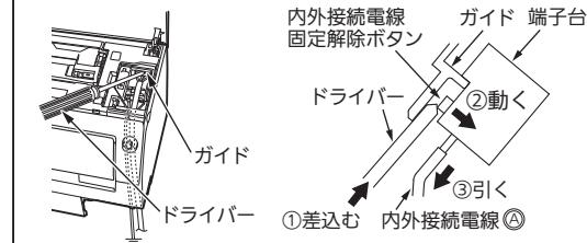
左図のように、端子台手前のガイドにドライバーを差込むことにより、内外接続電線固定解除ボタンが押され、内外接続電線⑨を引くと外すことができます。
