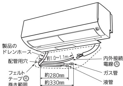
冷媒配管(内外接続配管)⑧の引込み長さの目安として、据付板①に記載の本体配管接続部の略図もご覧ください。
