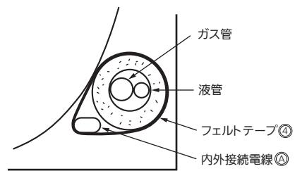
フェルトテープ④は、室内機裏側を通る配管の右端から左端まで全て必ず巻いてください。
