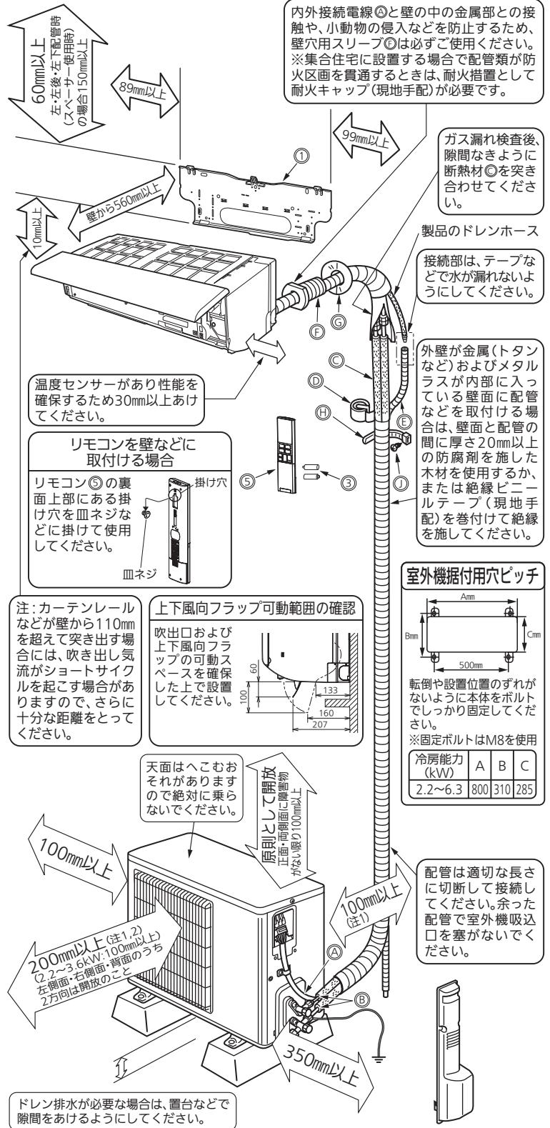
※上記の印寸法は、エアコンの性能を保証するために必要な空間です。後々のサービス、補修なども考慮してできるだけ周囲の空間が大きくとれる場所に据付けてください。
