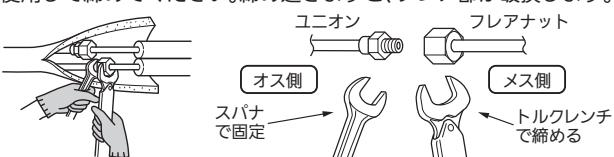
※フレアナットは製品に取付けられているものを使用してください。
