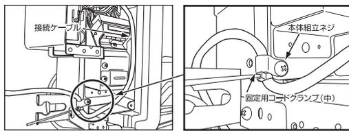
静電気による制御基板の破損防止のため、必ず静電気除去を行ってから作業してください。
