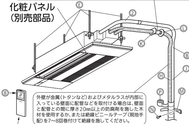
外壁が金属(トタンなど)およびメタルラスが内部に入っている壁面に配管などを取付ける場合は、壁面と配管との間に厚さ20mm以上の防錆剤を施した木材を使用するか、または絶縁ビニールテープ(現地手配)を7~8回巻付けて絶縁を施してください。
