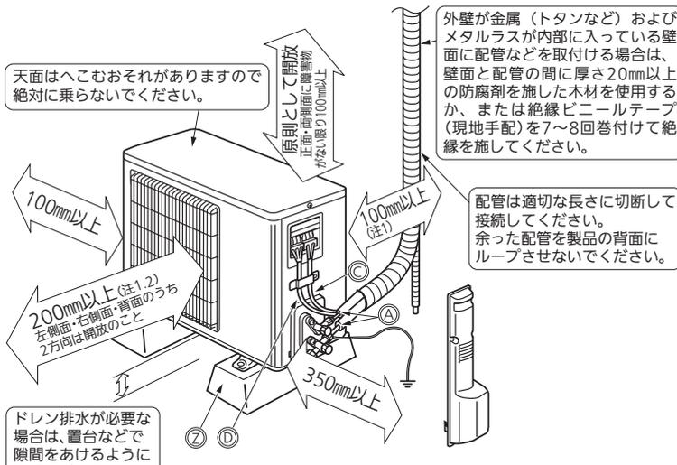
※上記の(←)印寸法は、エアコンの性能を保証するために必要な空間です。後々のサービス、補修なども考慮してできるだけ周囲の空間が大きくとれる場所に設置してください。
