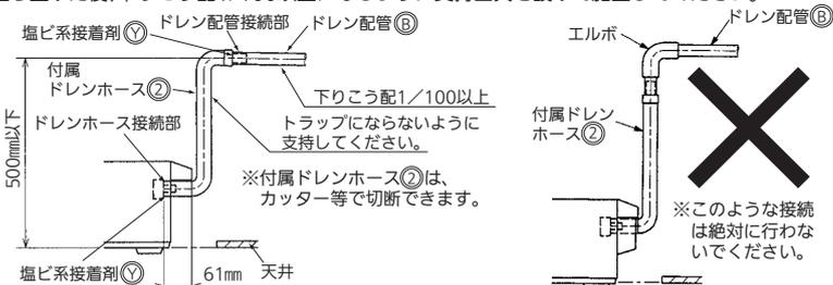
※ドレン出口の立ち上げ可能最大寸法は付属ドレンホース②が届く高さ(天井下面より高さ約500mm)ですが、可能な限り立ち上げ寸法は小さくしてください。
