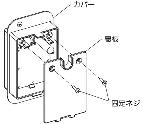
5. 受信基板をカバーから取外し、受信装置コードのコンネクターを抜いて延長コード①に交換します。
