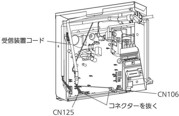
4. 受信装置裏側のネジ(2か所)を取外し、裏板を取外します。
